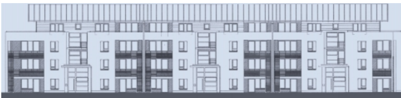
Südsicht eines Gebäudes mit Pultdach für Photovoltaikanlage.
